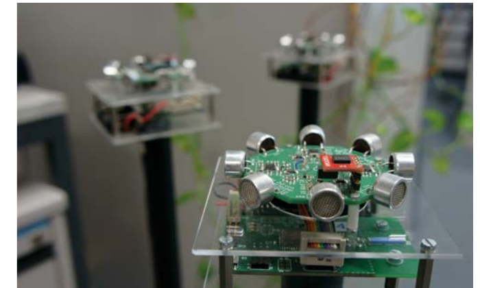
Die SpiderBat Plattform, die von einem unserer Studenten entwickelt wurde, erlaubt hochpräzise Distanz- und Winkelmessungen mittels Ultraschall.
